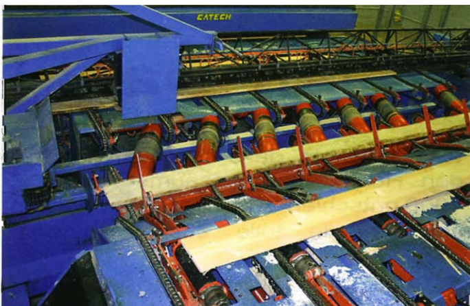
Spitzenleistungen von über 60 Stück pro Minute sind mit dem Catech 4000 bei van Roje realisierbar
