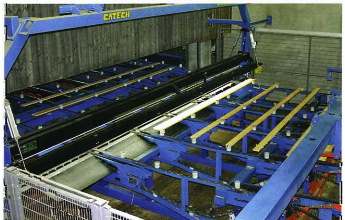
Hinter dem Besäumer wurde eine Kappschnitt-Optimierung von Fin-scan installiert – der Mechanisierungs-Part stammt von Almag
