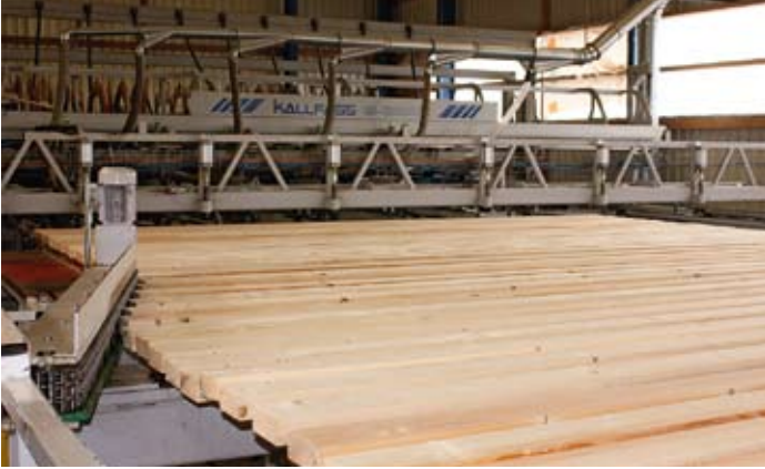
Mehrfach-Ablängsäge „Cross Cutting“ von Kallfass: sechs Kreissägen schneiden die Lagen punktgenau ab
