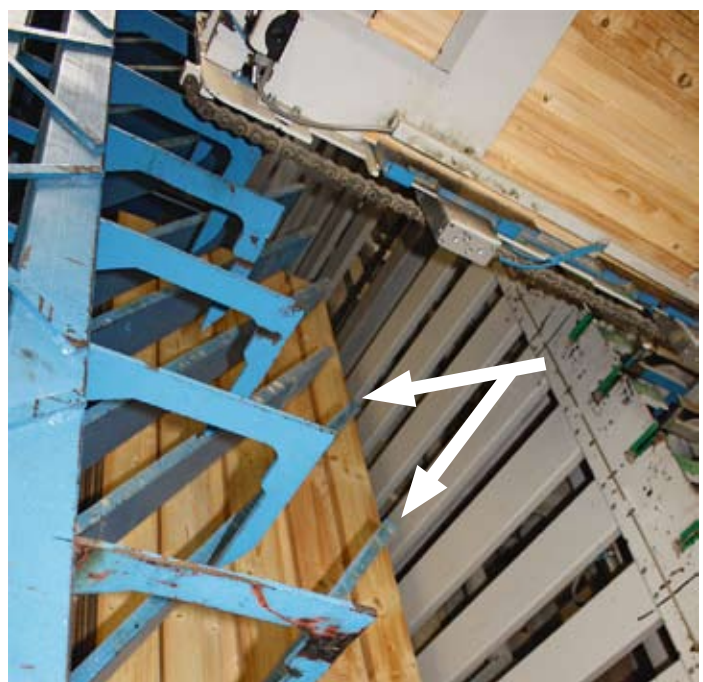
Hilfshubwerk: fertiges Paket fährt nach unten, der Fächer (Pfeil) klappt aus, damit ein neues Paket gebildet werden kann
