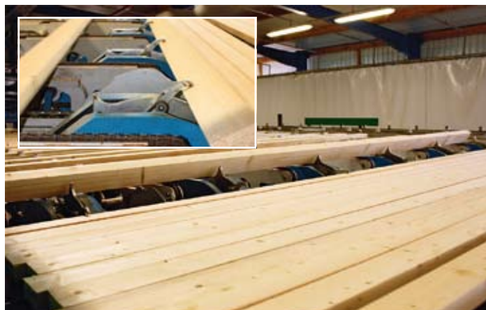
Vereinzelung der schwächeren Sortimente: bis zu 100 Takte pro Minute sind mit Tong-Loader möglich, eine Zange greift die Stücke (kleines Bild)
