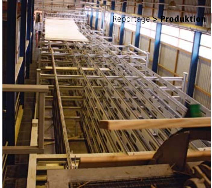
Filmetagen für schonenden Holztransport – die fünf Etagen sind bei Bedarf um vier erweiterbar
