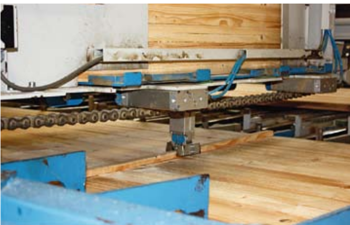
Hohe Genauigkeit: Verlust- und Trockenleisten werden mit Greifern exakt am Paket abgelegt
